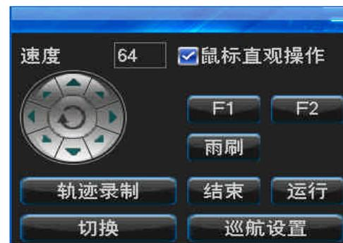
操作说明：要开启轨迹巡航功能，首先点“轨迹录制”，操作球机一段时间后（如：操作上下左右、速度、聚焦、变倍、光圈等），再点击“结束”，即录制完成；点击“运行”，此时球机会无限次重复刚才的运行轨迹，只有再次操作球机上下左右方向功能才能停止轨迹巡航。
